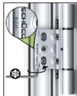
3 Dörrbladen höjs (vid det nedre gångjärn) och de andra gångjärn justeres därefter
