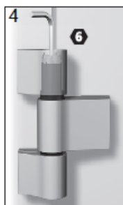
4 Glidlagret skruvas åt med +/- 90° fram tills den klickar in på plats.
