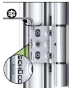
3 Dörrblad sänks (vid det nedre gångjärn) och de andra gångjärn justeras därefter
