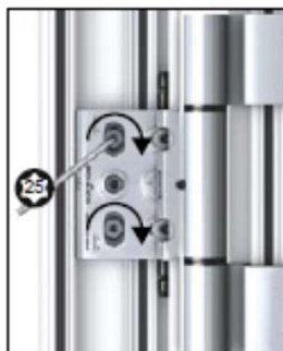
5 Skruva fast alla skruvar
